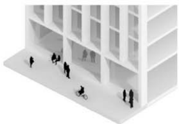
Eksempel på at strukturen fra facaden går til terrænen og skaber relief og nicher i bygningens stueetage
